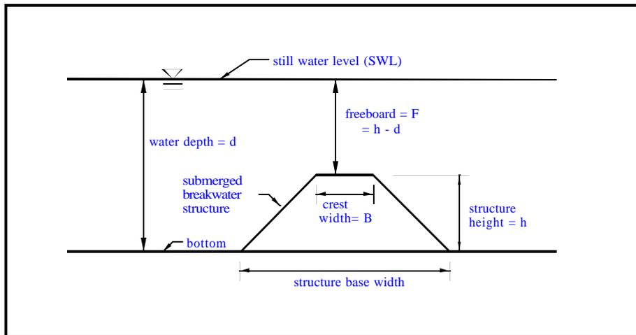
**Figure 1. DEFINITION SKETCH FOR A SUBMERGED BREAKWATER**
